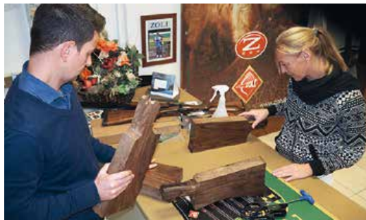
Schaftholz ist Geschmackssache! Viele Schützen setzen auf einen völlig geraden Verlauf der Maserung. Rechts die fertigen, grob herausgearbeiteten Schäfte 12 Stunden nach unserem ersten Besuch.
