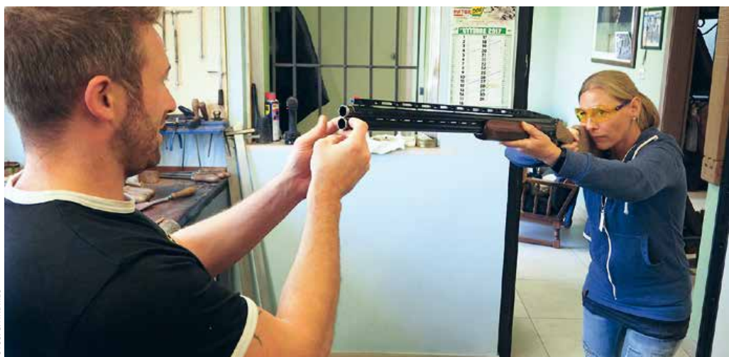
Giacomo Guerini eruiert die passende Position des Auges entlang der Laufschiene. Das Zentrum der Schiene ist gefragt.
